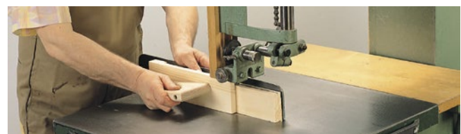
Abb. 3.1.6-10 Sägen kurzer Werkstücke mit Zuführhilfe
