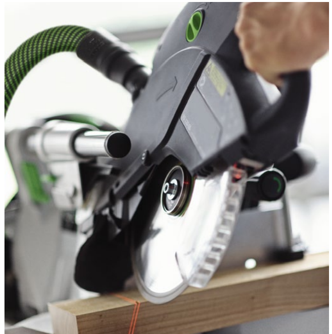
Abb. 3.1.4-04 Laser zur Anzeige der Schnittlinie
