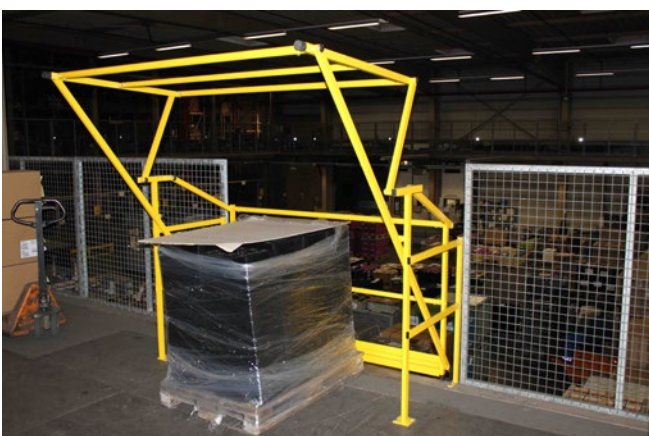
Abb. 3.4.3-05 Sicherheitschleuse für Lagerbühne
