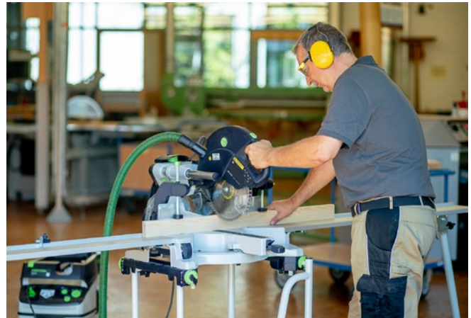
Abb. 3.1.4-02 Mobile Kapp-/Gehrungskreissägemaschine mit zusätzlicher Werkstückauflage
