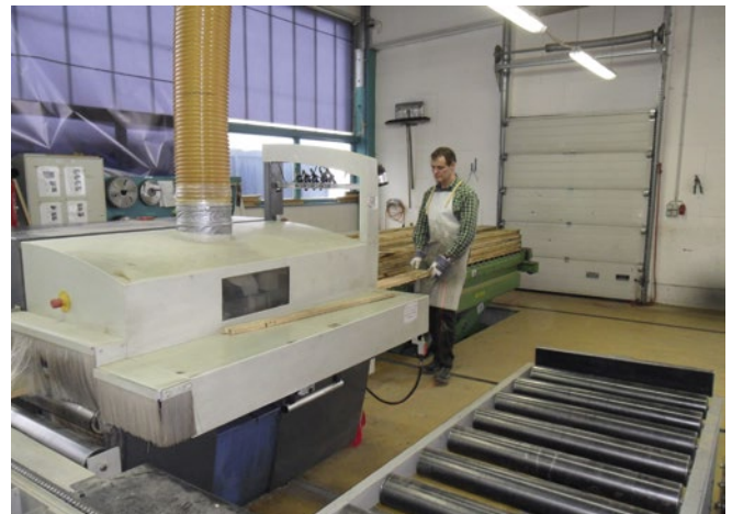
Abb. 3.1.14-07 Lederschürze mit Splitterschutz
