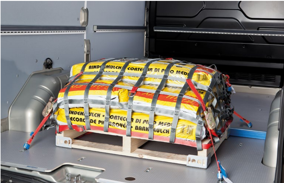
Abb. 3.5.6-02 Niederzurren eines freistehenden Ladungsguts
