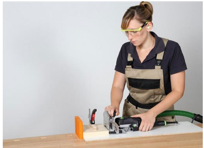
Abb. 3.3.5-02 Flachdübelfräse bei der Bearbeitung mit beiden Händen halten
