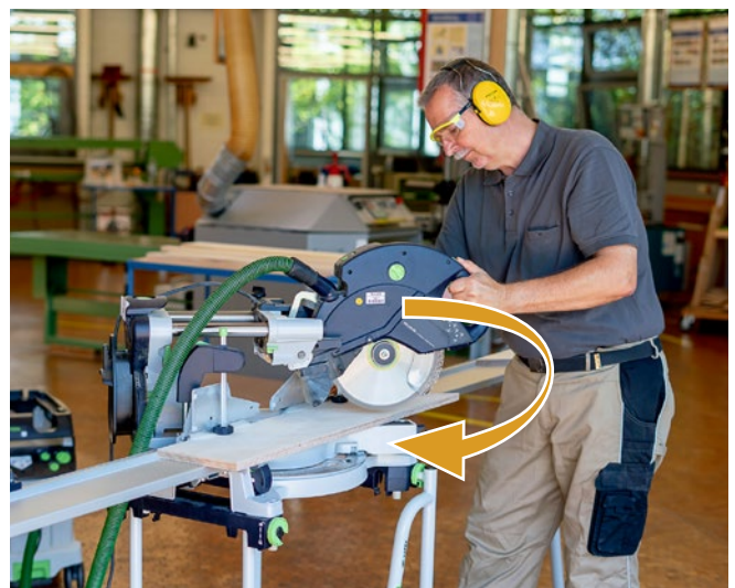
Abb. 3.1.4-05 Sägevorgang beim Einsatz der Zugfunktion
