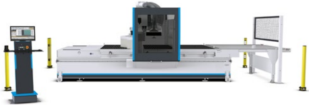
Abb. 3.1.11-02 CNC-Bearbeitungszentrum mit Zugangssicherung durch Lichtschranken
