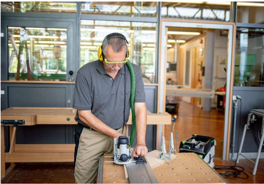
Abb. 3.3.2-03 Einfräsen von Nuten mit einer Führungsschiene
