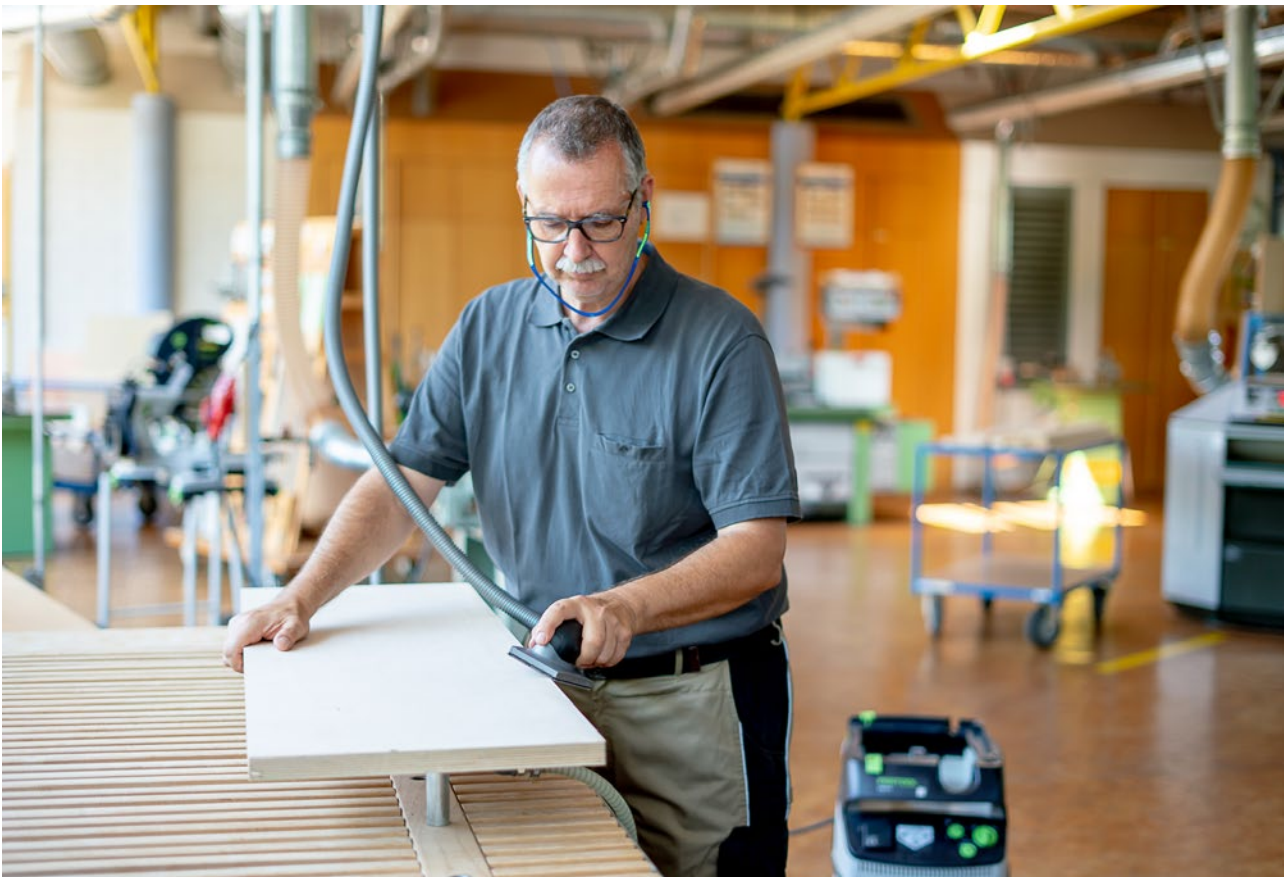
Abb. 3.3.6-01 Handschleifarbeiten mit abgesaugtem Handschleifklotz
