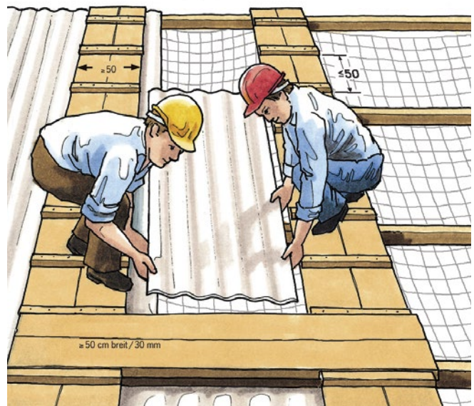
Abb. 3.5.2-04 Dachdeckung mit Wellplatten
