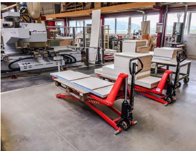
Abb. 3.2.1-04 Hubwagen mit Scherenhubfunktion
