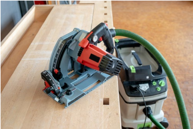
Abb. 3.3.1-09 Handkreissäge mit Absaugung
