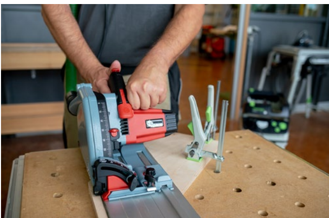
Abb. 3.3.1-10 Sägevorgang mit sicher fixiertem Werkstück
