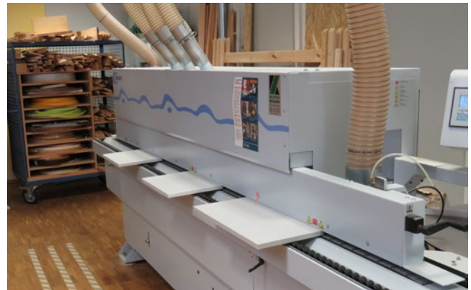
Abb. 3.1.12-04 Kantenanleimmaschine mit Absauganschlüssen
