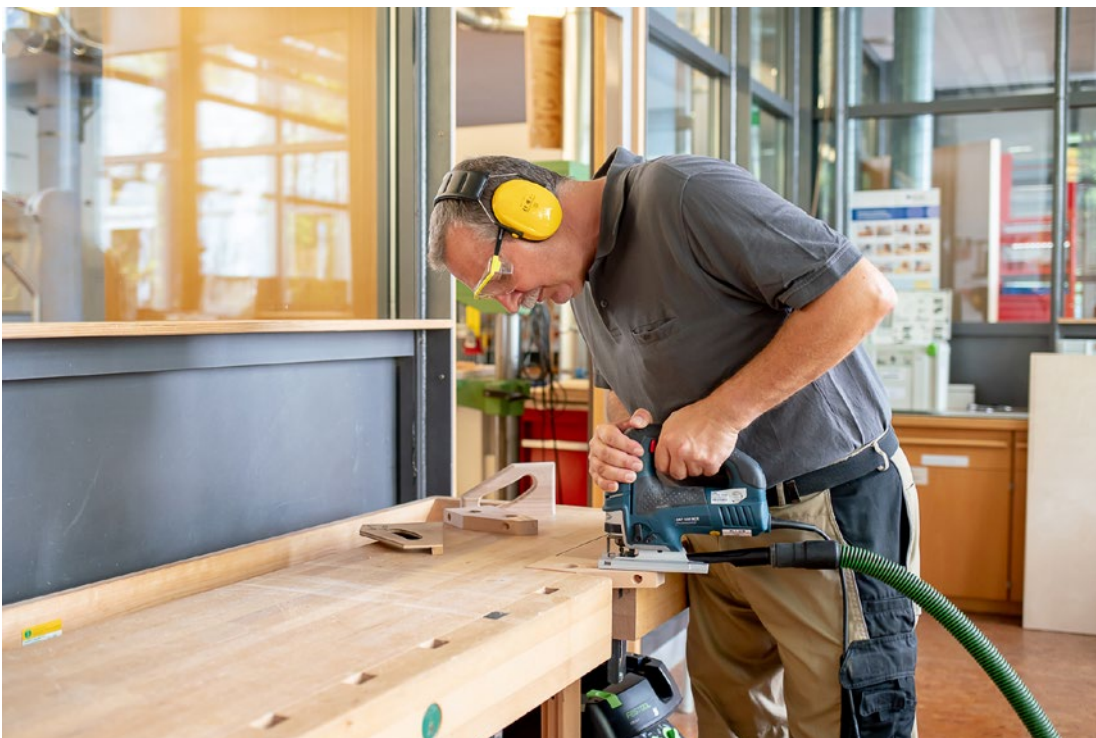
Abb. 3.3.4-02 Werkstücke sicher aufliegen und fixieren
