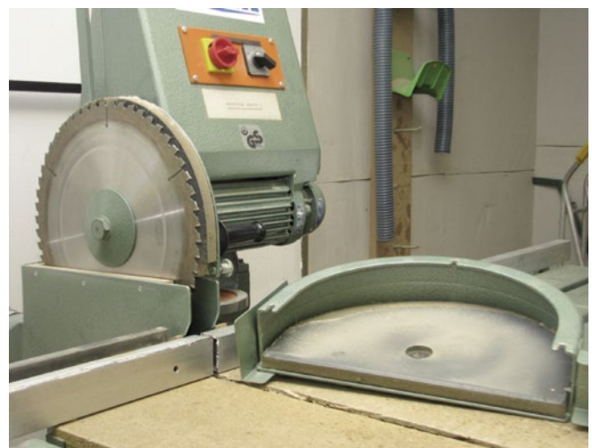
Abb. 3.1.5-07 Auskleidung an Schutzhaube zur Lärmreduzierung
