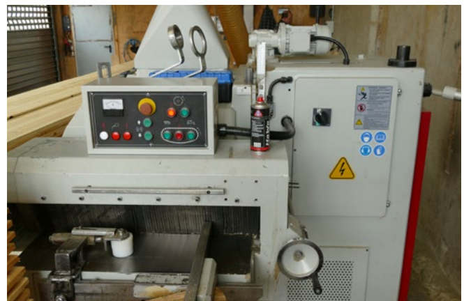
Abb. 3.1.14-04 Einschubbereich mit Splitterfänger
