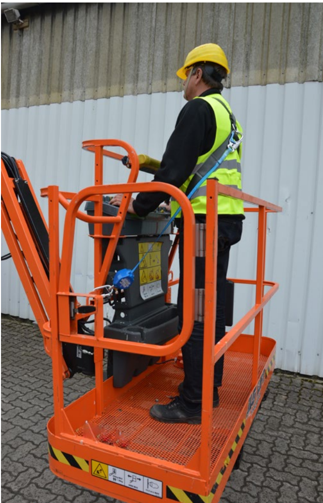
Abb. 3.5.4-02 Einsatz eines Höhensichtungsgeräts im Arbeitskorb
