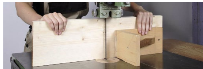
Abb. 3.1.6-08 Quersägen hochkant stehender Werkstücke
