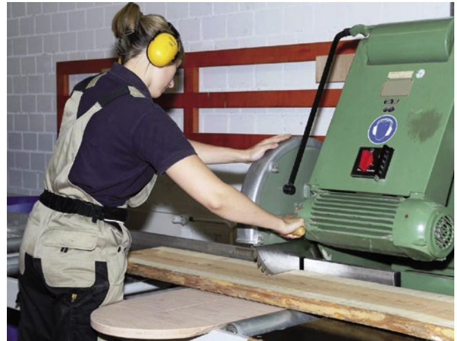
Abb. 3.1.5.06 Handhaltung beim Sägevorgang an einer Pendelkreissägemaschine
