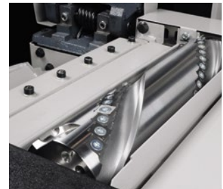
Abb. 3.1.9-08 Spiralhobelmesserwelle mit Einwegwendemessern
