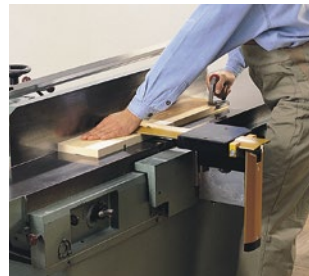
Abb. 3.1.9-07 Schwenkbarer Hilfsanschlag (Abrichten schmaler Leisten)
