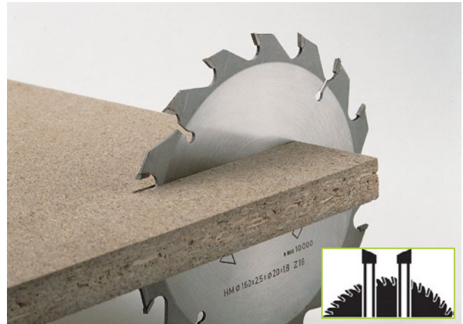
Abb.3.3.1-06 HM-Wechselzahn Für alle Holzwerkstoffe, Baustoffplatten und weiche Kunststoffe.
