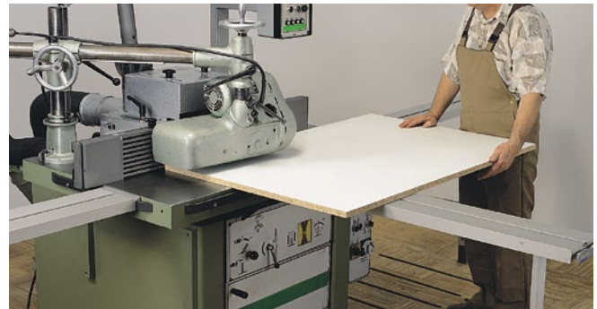
Abb. 3.1.8-04 Handvorschub = Arbeiten mit dem Vorschubapparat
