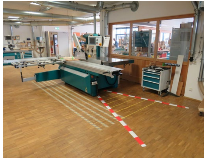
Abb. 2.2.2-02 Gefahrbereich vor einer Formatkreissäge (hier z. B. rot-weiß gekennzeichnet)
