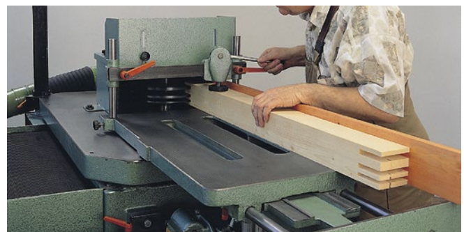
Abb. 3.1.8-05 Handvorschub = Arbeiten mit dem Schiebeschlitten
