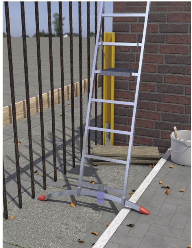
Abb. 3.5.5-02 Leiterfuß zum Ausgleich von Niveauunterschied
