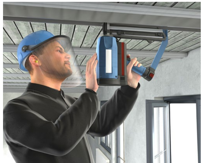
Abb. 3.3.7-03 Eintreibgerät mit Auslösesicherung
