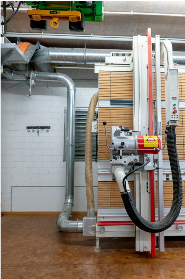
Abb. 3.1.2-07 Absauganlage an einer vertikalen Plattensäge
