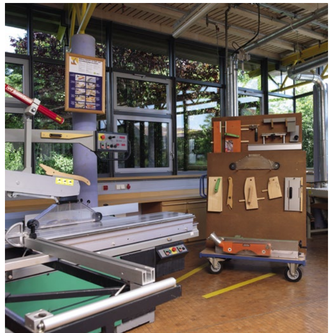
Abb. 2.2.2-04 Formatkreissäge mit zugehörigen Schutzvorrichtungen
