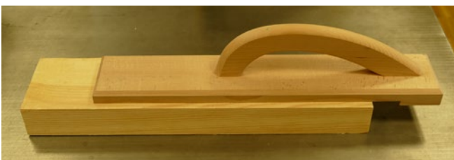
Abb. 3.1.9-05 Zuführlade und Schiebeholz für kurze Werkstücke
