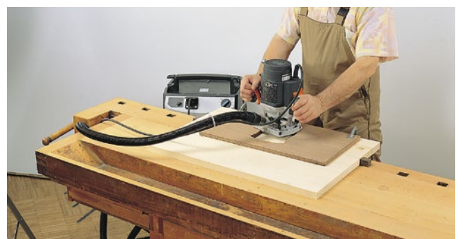
Abb. 3.1.8-06 Handvorschub = Arbeiten mit Handmaschinen
