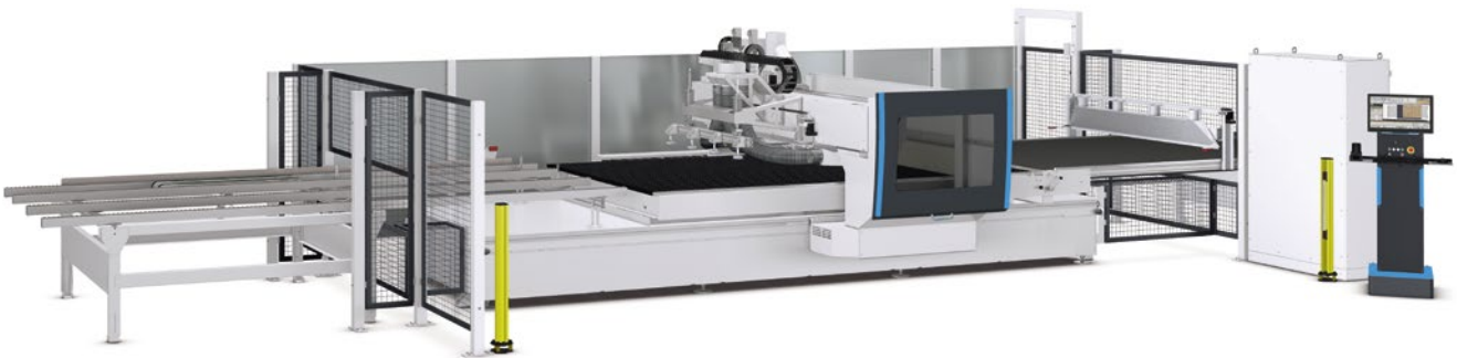
Abb. 3.1.11-01 CNC-Bearbeitungszentrum mit Schutzzaun und Kontakttrittmatte
