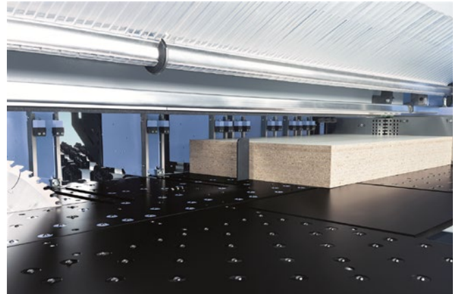
Abb. 3.1.3-02 Hohes Plattenpaket mit Winkelandrückvorrichtung
